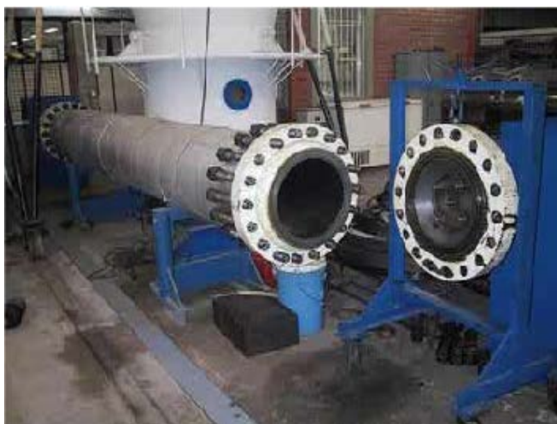
Figura 18: Exemplo de câmara hiperbárica horizontal no LTS (COPPE/UFRJ)
