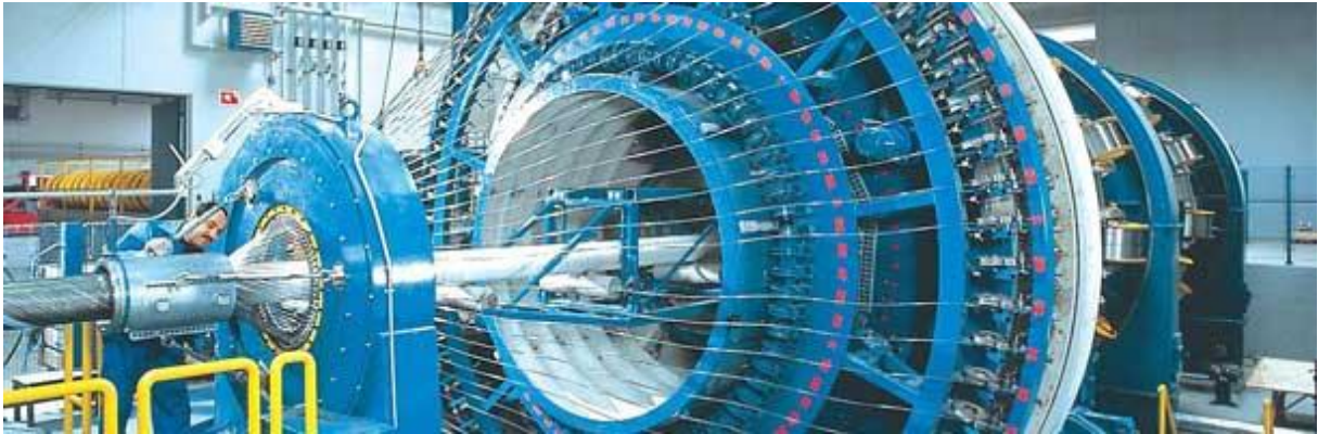
Figura 29: Ilustração da etapa de fabricação da armadura de tração.[28]
