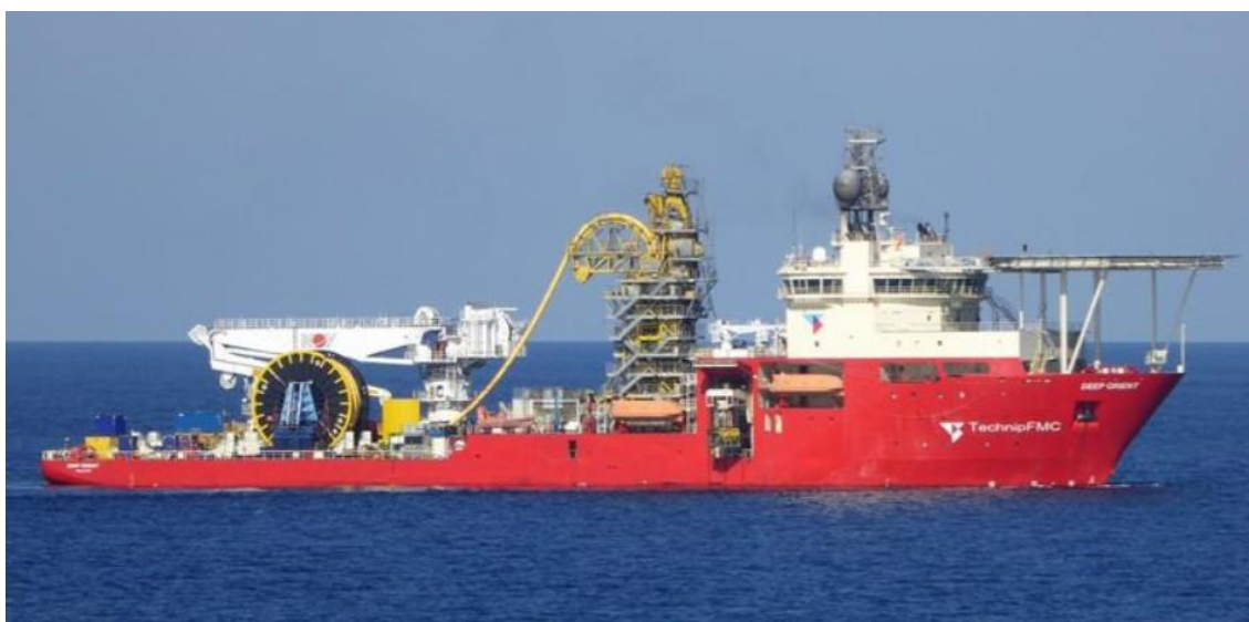
Figura 1: Embarcação de Lançamento e Instalação de risers . [15]
