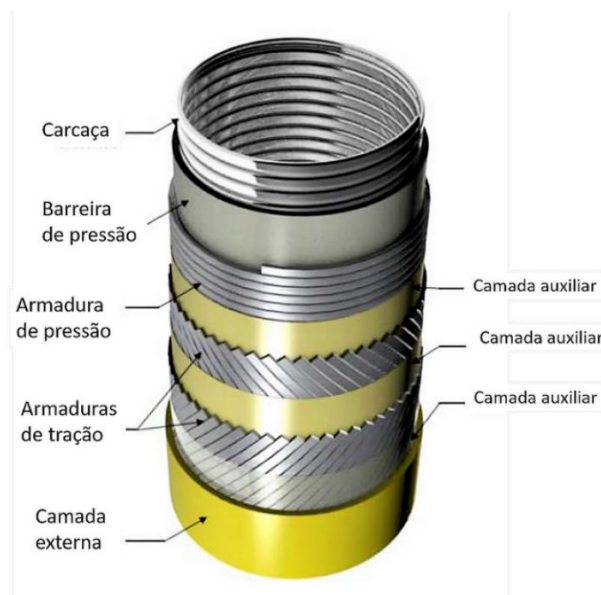
Figura 15: Camadas do Tubo Flexível
