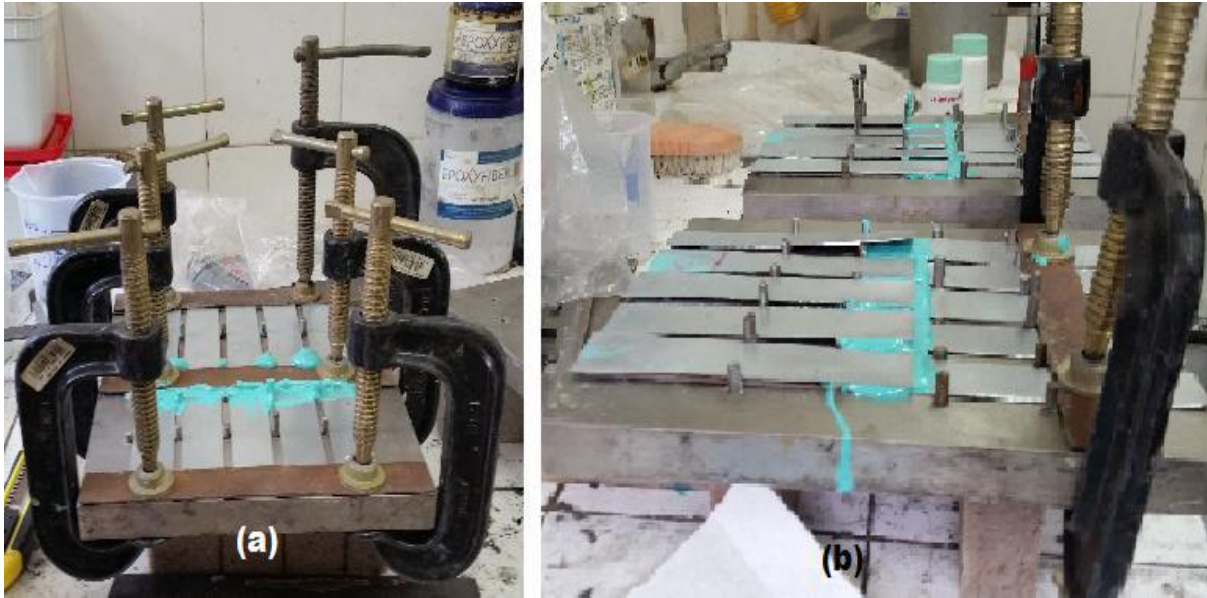
Figura 13: a) Apoio para preparação das juntas coladas e juntas híbridas. b) Amostras de juntas coladas. As microestruturas das juntas soldas foram examinadas utilizando um microscópio óptico. [20]
