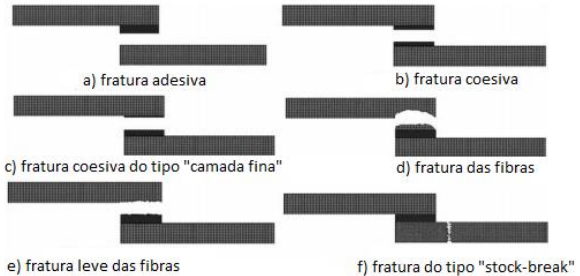
Figura 19: Possíveis tipos de fratura em juntas de sobreposição simples. [22]
