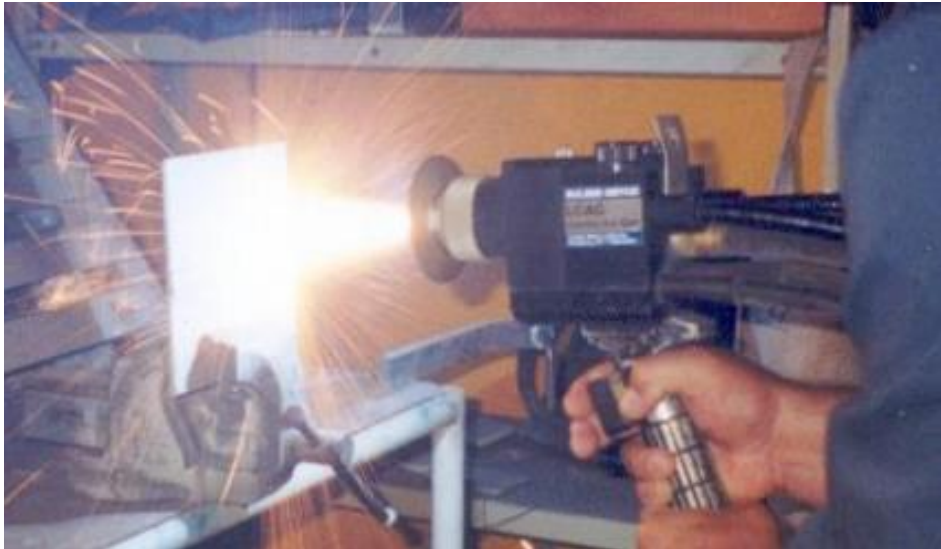
Figura 26 - Exemplo de método de aplicação de aspensão térmica [11]
