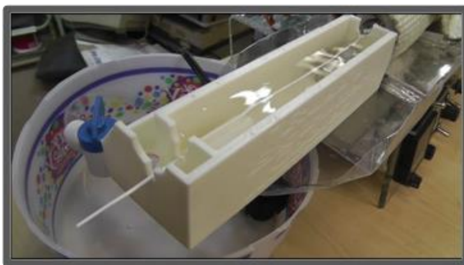
Figura 18 – Filamento sendo resfriado em água. [36].
