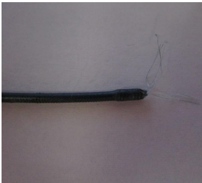
Figura 15 – Filamento que sofreu inchamento. [14].
