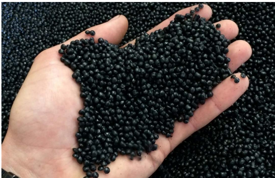
Figura 2 – Pellets de ABS que, após serem fundidos na extrusora, se tornam os filamentos. [32].
