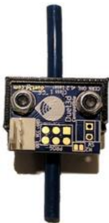
Figura 26 – Filamento atravessando o sensor durante medição. [15]
