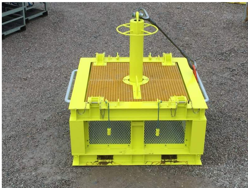
Figura 59 - Exemplo de Estrutura para Acondicionamento de Equipamentos Submarinos
