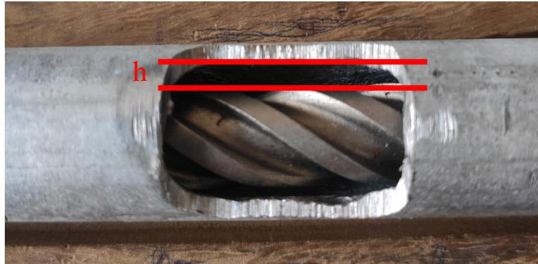
Figura 37 - Diferença entre a broca e parede interna do tubo.
