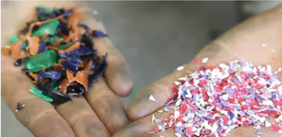
Figura 16 - Diferença entre plástico triturado sem tela calibrada (esquerda) e com tela calibrada (direita).
