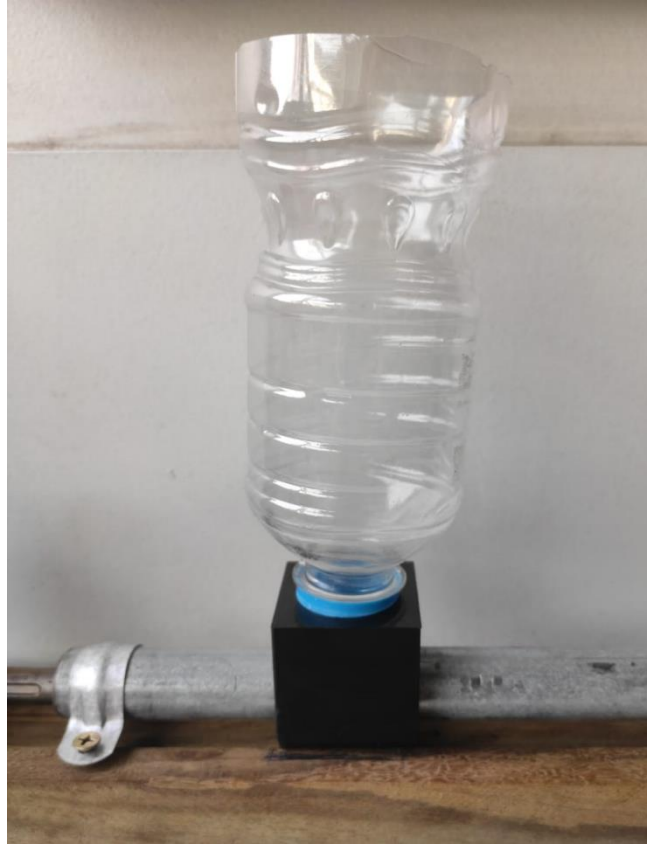
Figura 32 - Sistema de alimentação.
