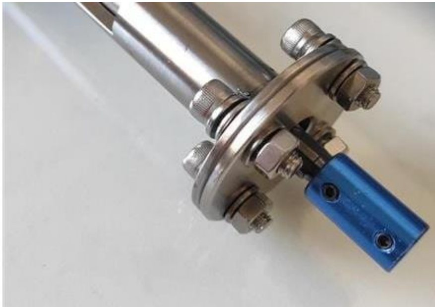
Figura 40 - Montagem do flange
